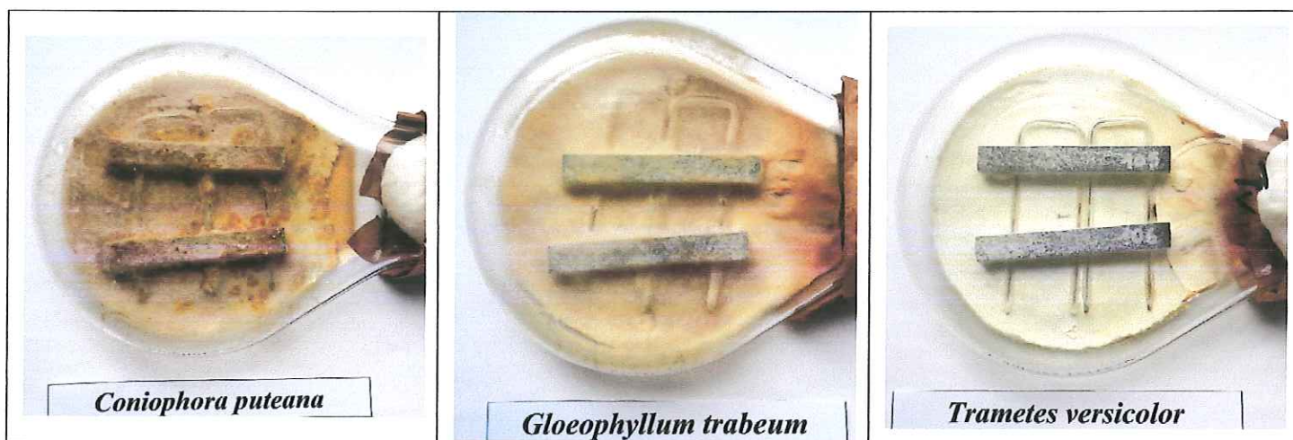
Fot.2. Porośnięcie próbek przez grzyby podstawczaki na końcu badania.
