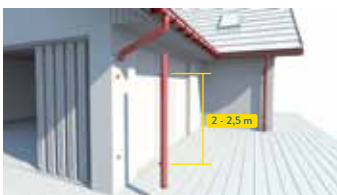
Montaż obejmy rury spustowej
